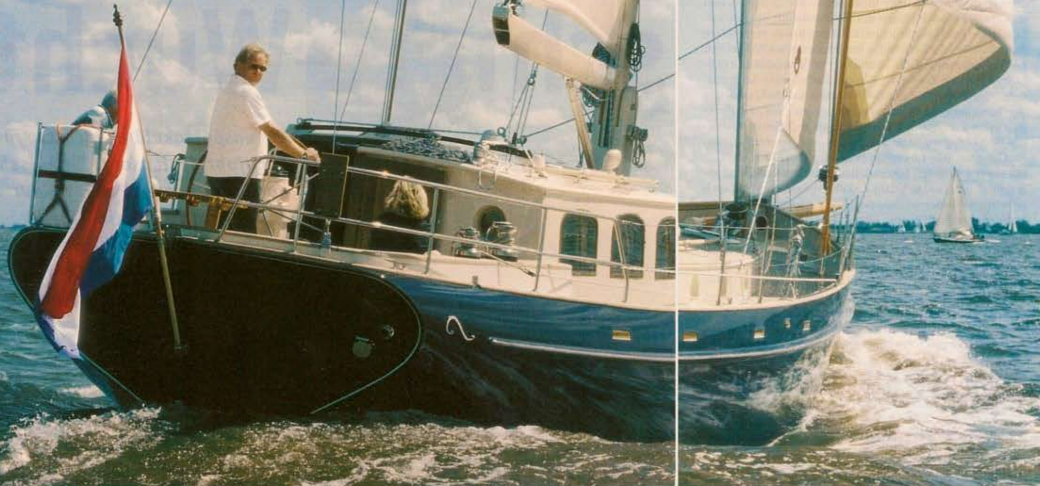
Die äußeren Puffin-Charakteristika auf einen Blick: angehängtes Ruder am herzförmigen, positiv geneigten Spiegelheck, kantiges Deckshaus mit klassischen Fenstern, Tabernakel für den Klappmast und der Bugspriet
